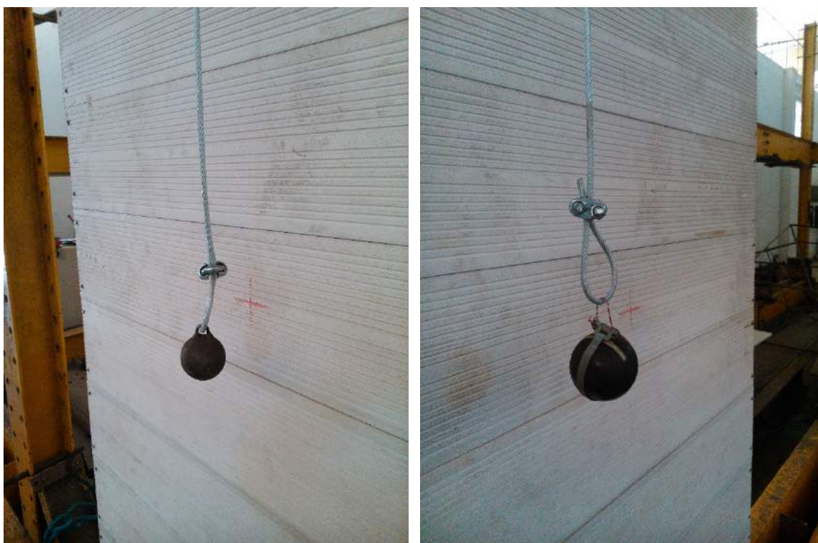
Figura 70: Esfera de aço de 0,5kg (à esquerda) e de 1,0kg (à direita) alinhadas ao centro do painel.
