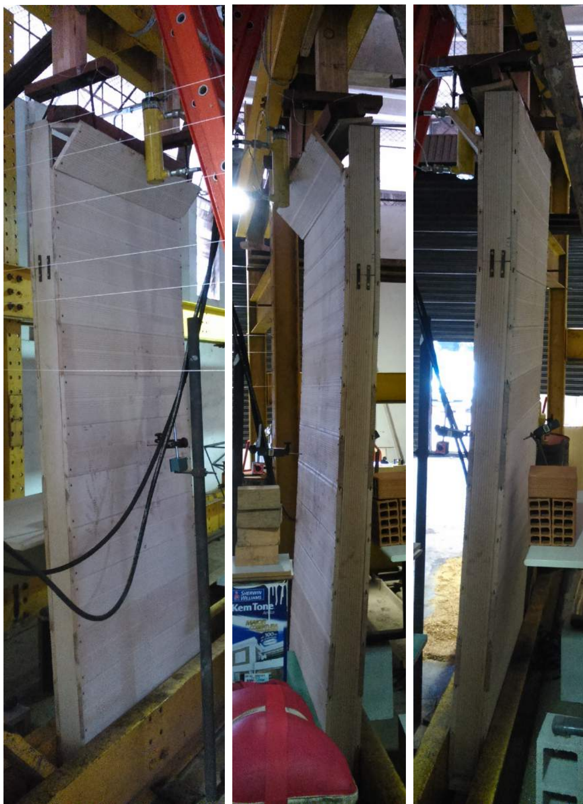
Figura 99: Ruptura da última peça da parede externa do CP 2 no ensaio de resistência à compressão.
