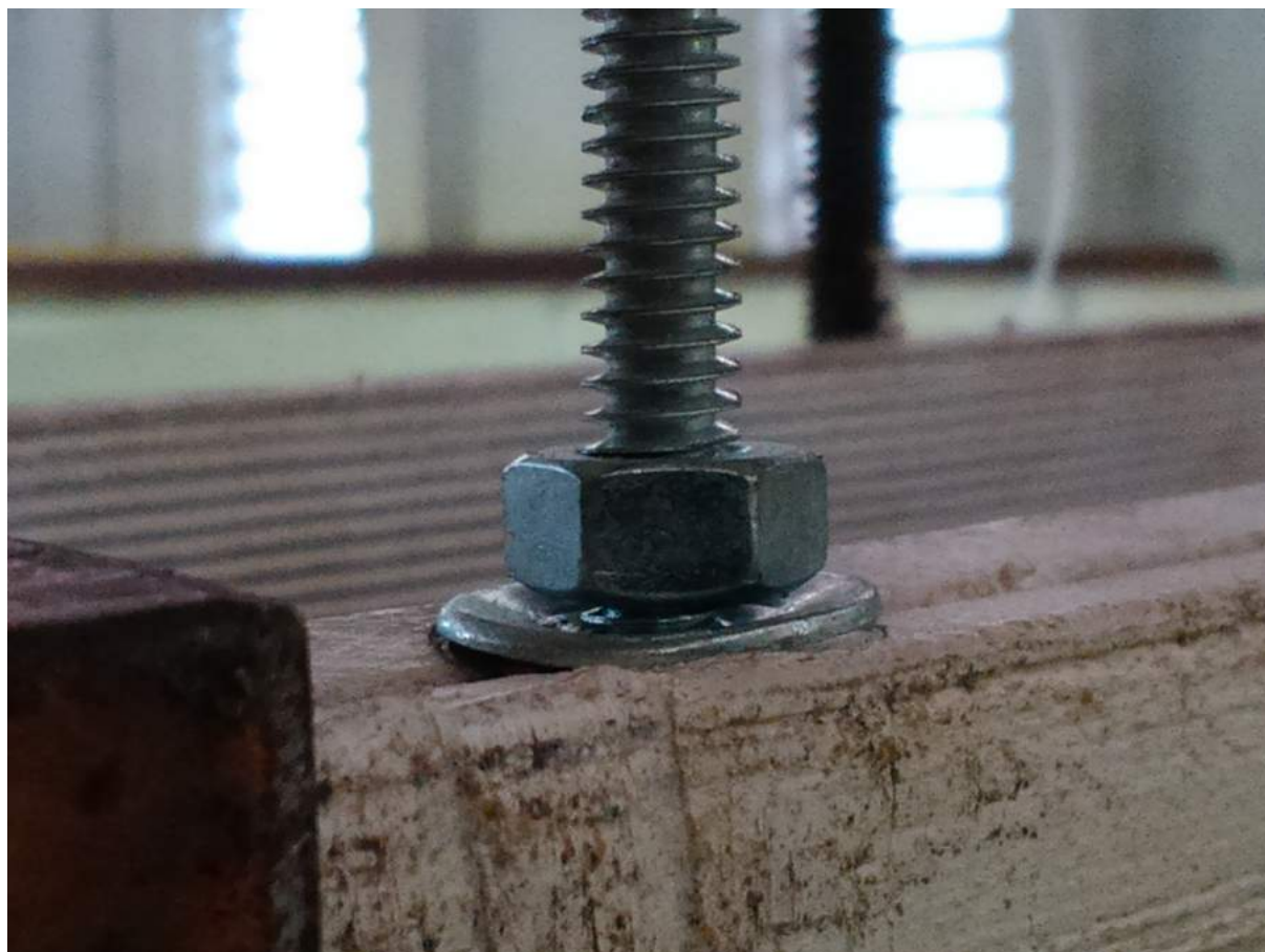
Figura 89: Porca afrouxada com o último impacto (h = 1,80m). Protótipo CP 2.
