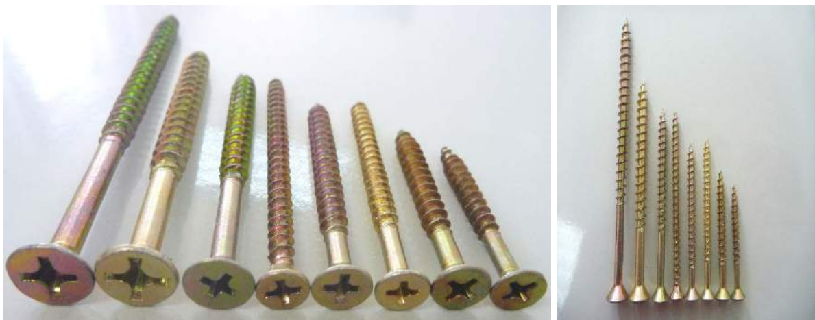
Figura 39: Diferentes tipos de parafusos autoatarraxantes testados. Da esquerda para a direita: 6 x 90; 6 x 69; 5 x 60; 4 x 58; 4,5 x 49; 4 x 49; 4,5 x 39 e 4 x 35 (diâmetro x comprimento, medidas em milímetros).
