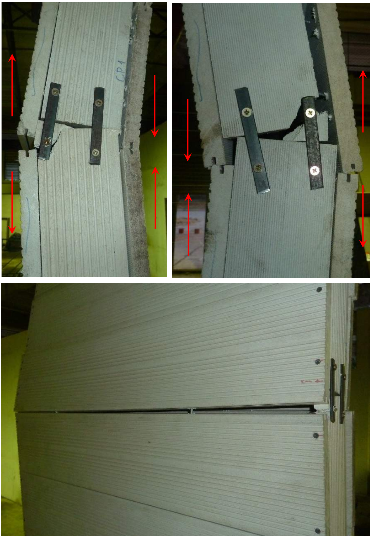
Figura 98: Montante esquerdo (acima e à esquerda), montante direito (acima e à direita) e parede traseira (abaixo) do CP 1 rompido no ensaio de resistência à compressão. Percebe-se que as peças de uma face do painel tendem a se aproximar (compressão), enquanto as da face oposta tendem a se afastar (tração).
