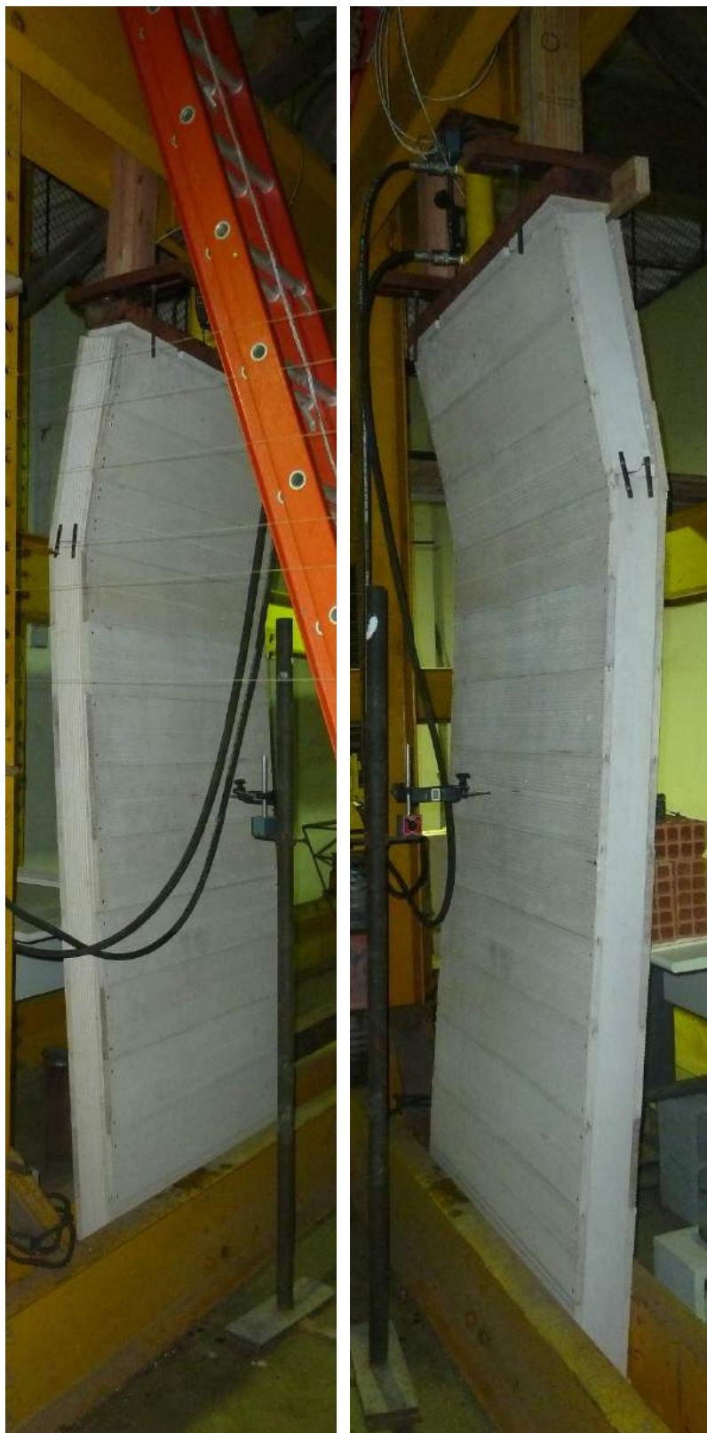
Figura 97: Deslocamento sofrido pelo CP 1 com o ensaio de resistência à compressão. À esquerda, montante lateral esquerdo. À direita, montante lateral direito.
