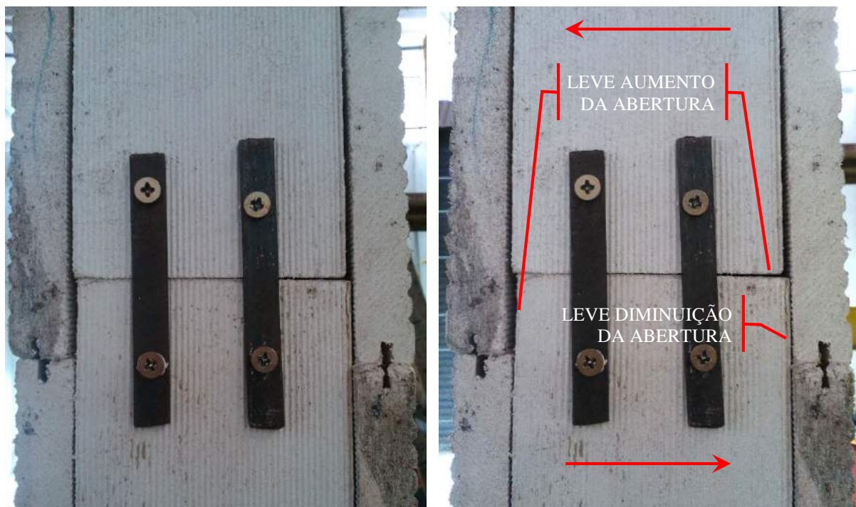
Figura 93: CP 3 após impactos de 0,90m (à esquerda) e 1,80m (à direita).
