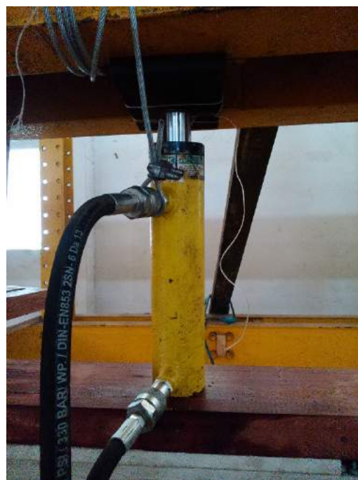
Figura 75: À esquerda, manômetro da bomba hidráulica; à direita, cilindro hidráulico utilizado.
