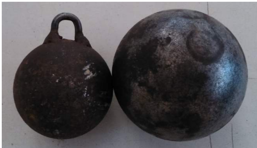
Figura 68: Esfera de 0,5kg (à esquerda) e de 1,0kg (à direita) utilizadas no ensaio.
