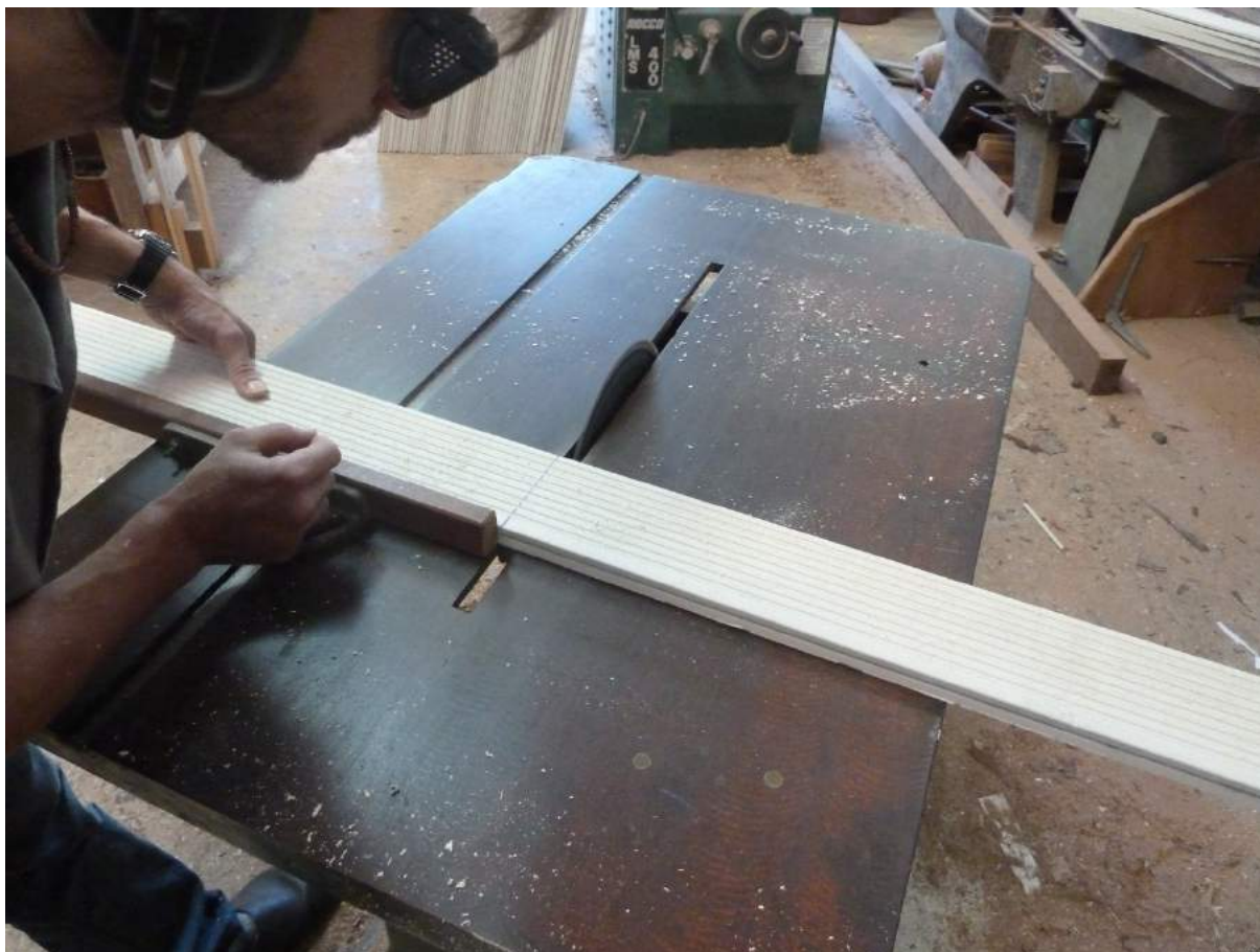
Figura 52: Peça de 21mm x 100mm x 2000mm sendo cortada para produzir peças de 21mm x 100mm x 570mm (espessura x largura x comprimento).
