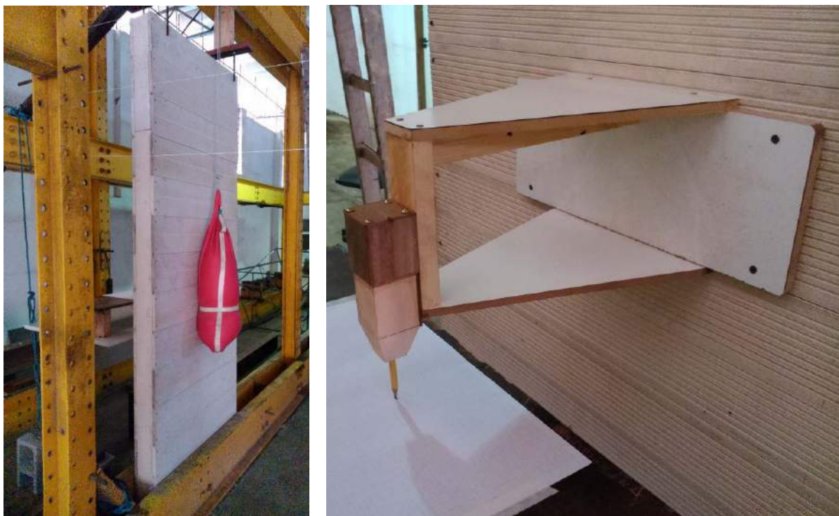
Figura 73: Saco de couro alinhado ao centro do painel (à esquerda) e dispositivo para a medição dos deslocamentos horizontais (à direita).
