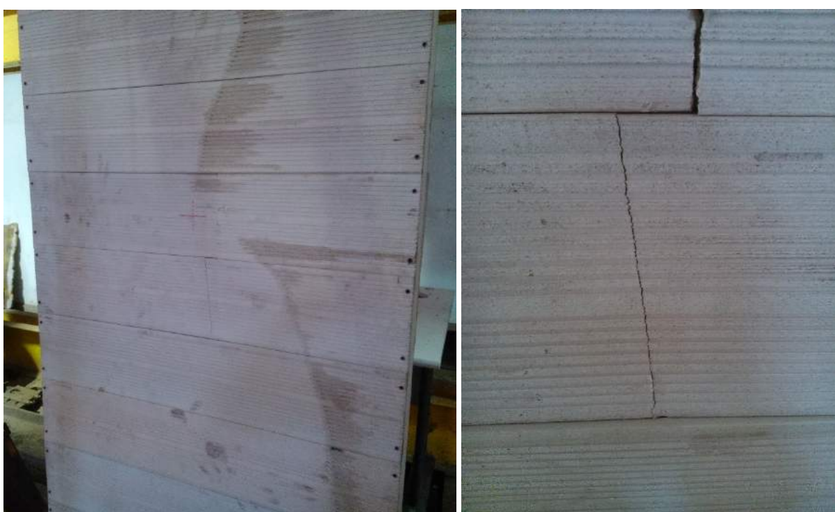
Figura 92: Peça abaixo da peça central da parede externa rompida com o impacto (h = 1,80m). Protótipo CP 3.
