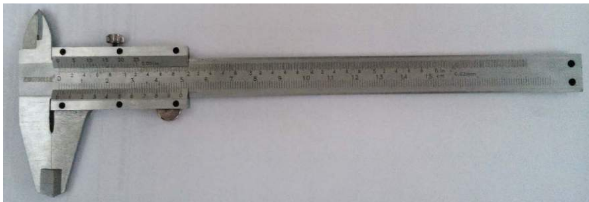
Figura 69: Paquímetro com resolução de 0,02mm utilizado no ensaio.
