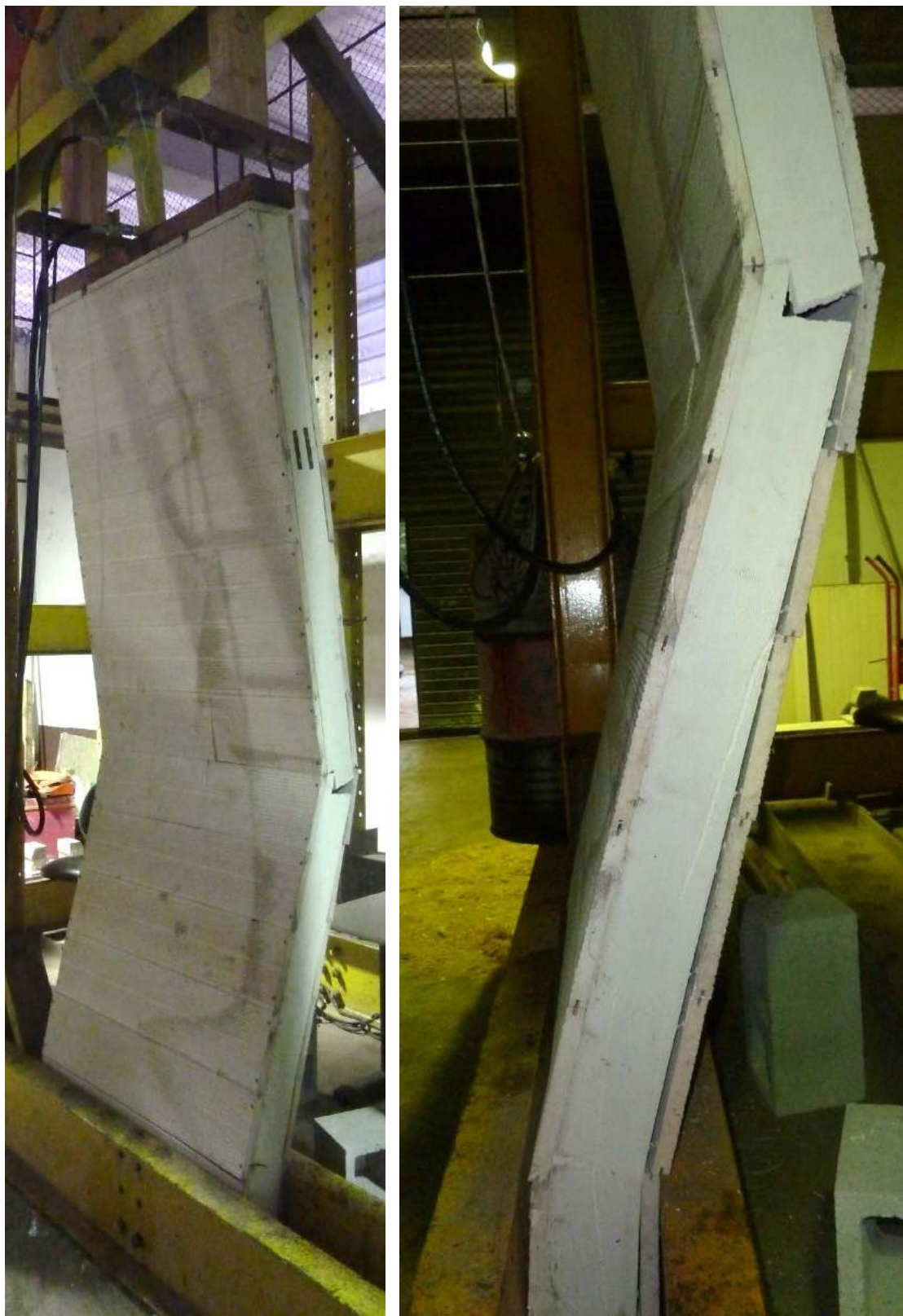
Figura 101: CP 3 após o ensaio de resistência à compressão.
