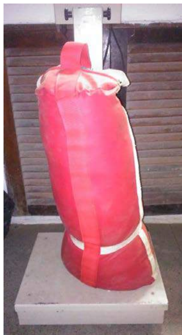
Figura 72: Saco de couro com 40kg de mistura de areia e serragem.
