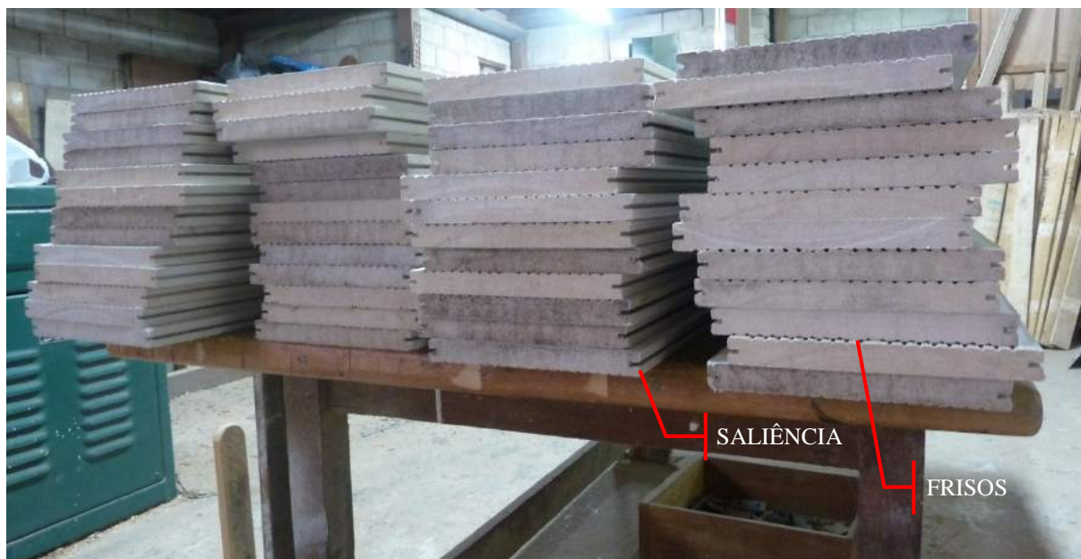
Figura 38: Vista da seção transversal dos perfis. É possível ver as pequenas saliências existentes nas extremidades dos perfis e os frisos em suas faces.
