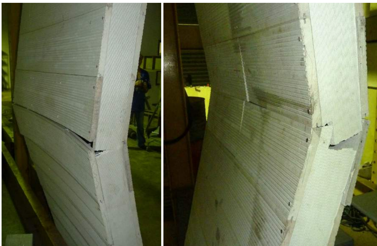
Figura 103: Montantes rompidos no local de engaste do painel.
