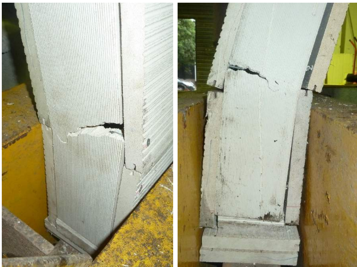
Figura 103: Montantes rompidos no local de engaste do painel.
