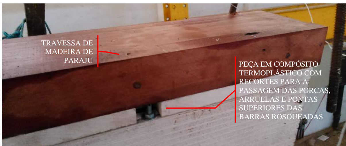
Figura 78: Peça de madeira de Paraju e de compósito termoplástico utilizadas para distribuir a carga aplicada pelo cilindro hidráulico.
