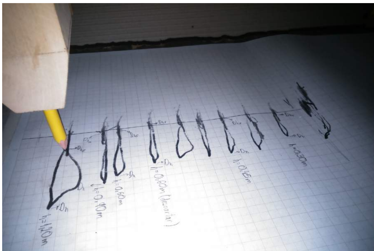
Figura 86: Registro dos deslocamentos sofridos pelo CP 1. Alguns dos impactos foram descartados. É possível ver ainda a marcação na folha milimetrada dos pontos de deslocamento horizontal instantâneo ( D_h ) e residual ( D_{hr} ) do painel para cada altura de abandono.
