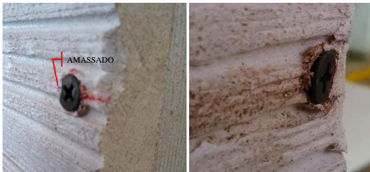
Figura 82: Dois parafusos distintos deformados com os impactos das esferas de aço. À esquerda, parafuso com a cabeça amassada no lado esquerdo; à direita, parafuso com a cabeça entortada para o lado direito.
