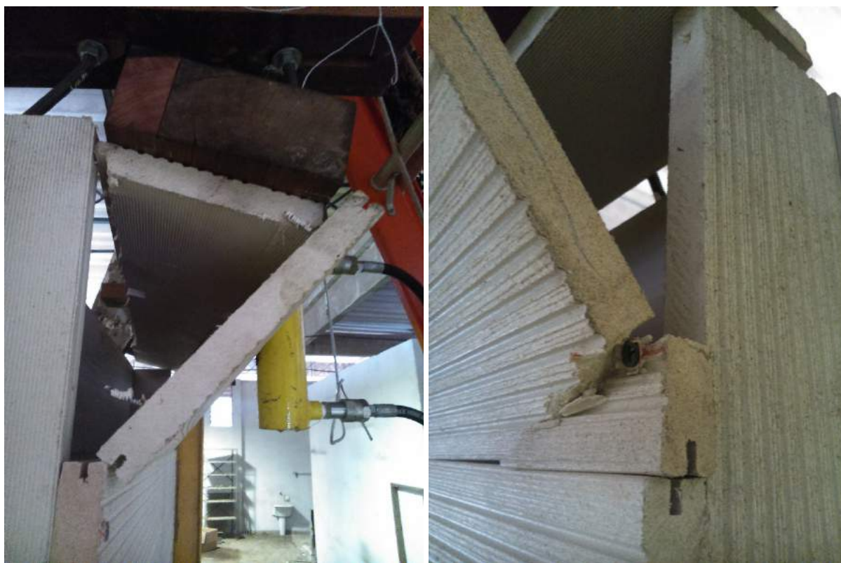
Figura 100: Peça superior da parede externa arrancada no ensaio de resistência à compressão. À direita, quina rompida.
