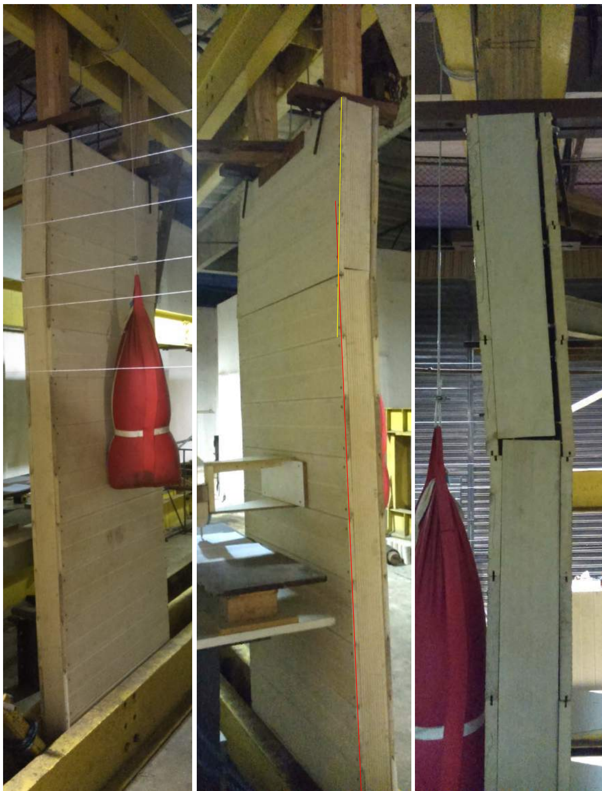
Figura 85: Ruína do protótipo ocorrida para a altura de abandono de 1,20m.
