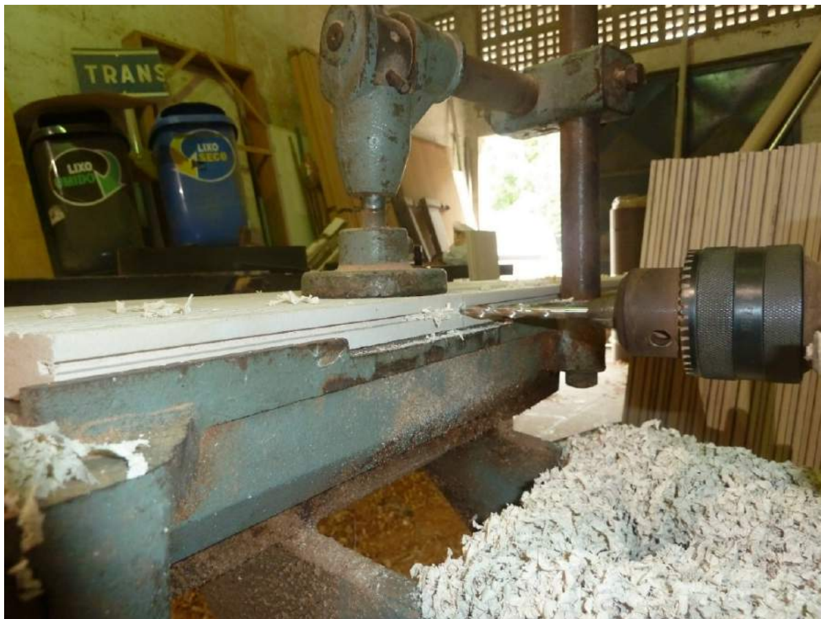
Figura 54: Peça de compósito de 21mm x 200mm x 1000mm sendo furada com broca 5/16".
