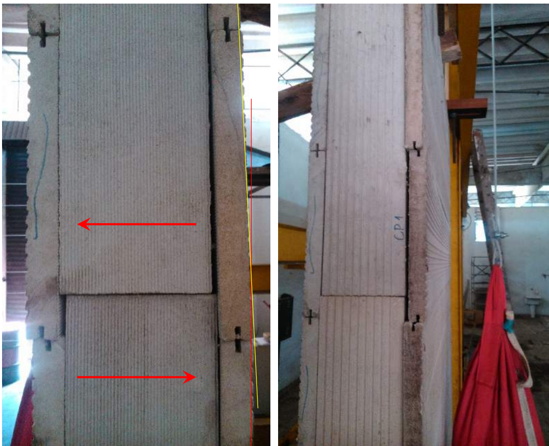
Figura 84: Parafusos das peças superiores rompidos para as alturas de 0,60m e 0,90m.
