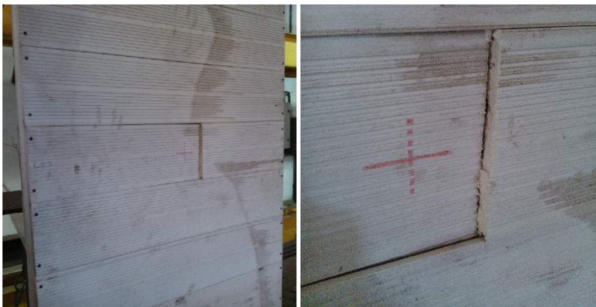
Figura 92: Peça abaixo da peça central da parede externa rompida com o impacto (h = 1,80m). Protótipo CP 3.
