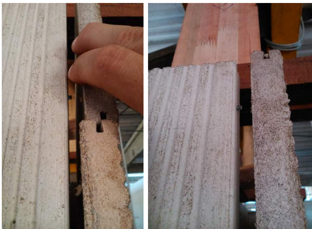
Figura 84: Parafusos das peças superiores rompidos para as alturas de 0,60m e 0,90m.
