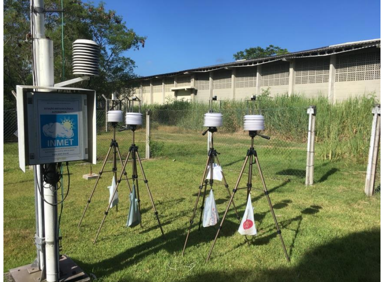
Figura 22: Teste dos equipamentos junto à estação meteorológica Vitória-A612/INMET.
