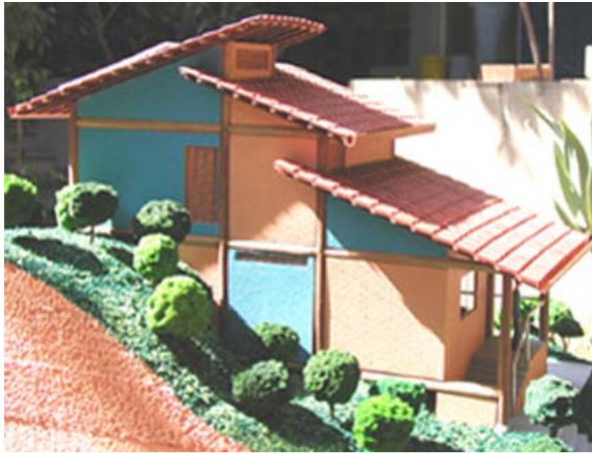
Figura 1 - Maquete com a proposta de habitação em estrutura de eucalipto e vedação em solo-cimento.
