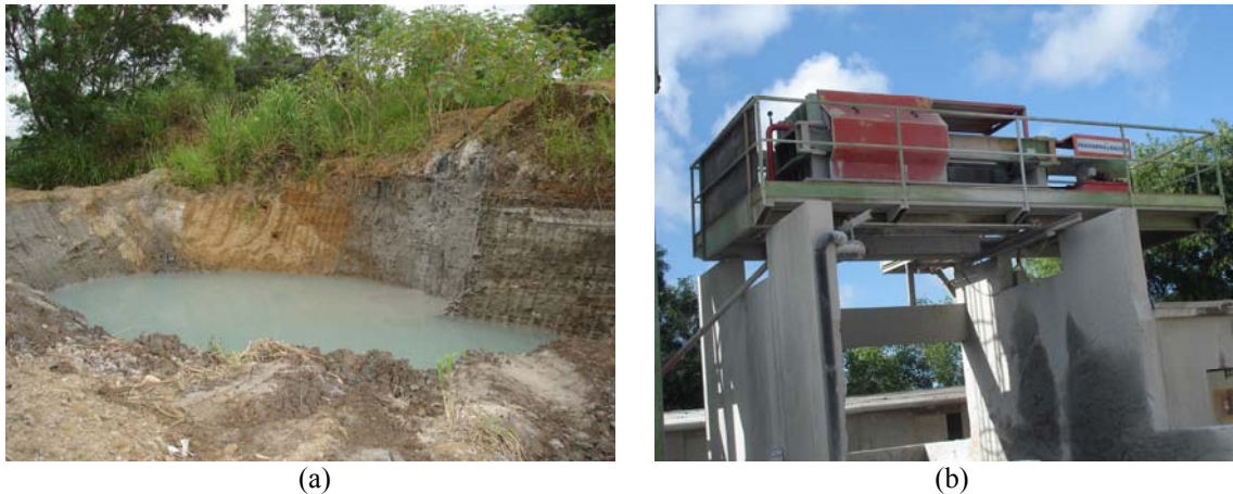
Figura 2 – (a) Lagoa de sedimentação de resíduo de corte de rochas ornamentais no pátio da empresa; (b) filtro prensa.
