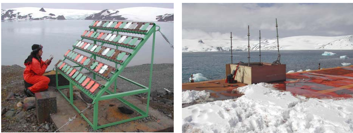
Figura 4 – À esquerda, a Estação de Corrosão Atmosférica instalada na EACF com os corpos de prova instalados e, à direita, coleta para mensuração do resíduo gerado no tratamento das superfícies.
