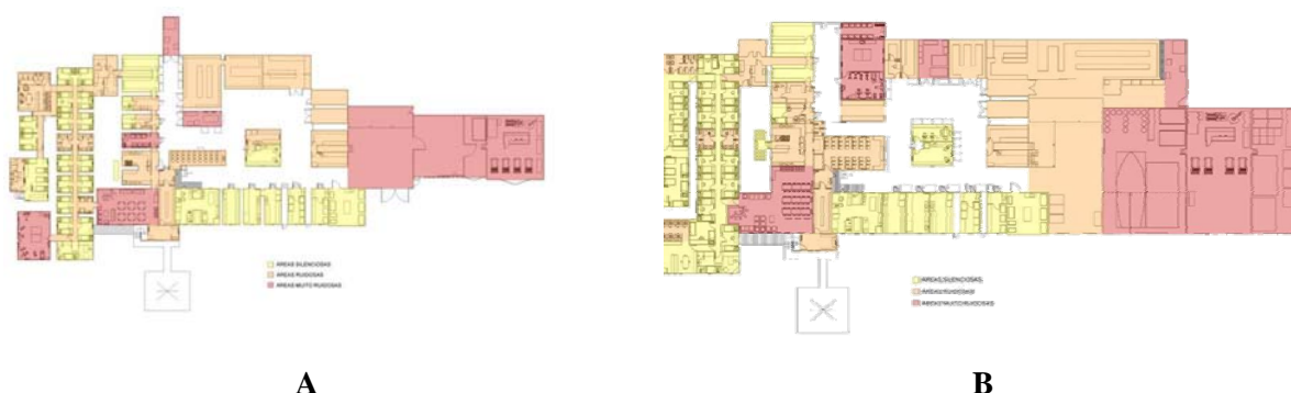
Figura 7 – Zoneamento Acústico (conceitual) do layout atual (A), elaborado para orientar decisões relativas às alterações propostas na reconfiguração espacial da EACF, na qual se buscou uma setorização de acordo com os níveis de pressão sonora relativos (B).
