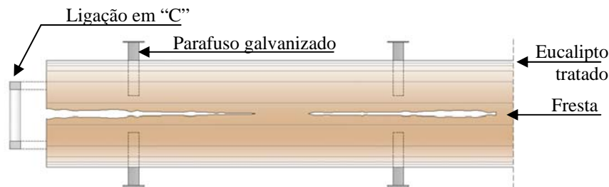
FIGURA 8 – Exemplo de instalação de parafuso ao longo da peça de madeira. Fonte: Estuqui Filho (2006).
