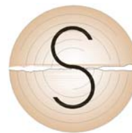
FIGURA 7 – Peça de madeira com união metálica em “S”. Fonte: Estuqui Filho (2006).
