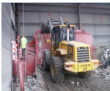
**Figura 04** - Transporte do RCD para o alimentador vibratório.
