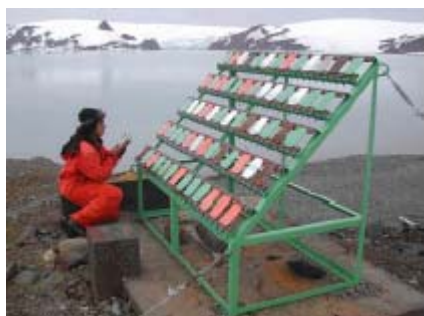
Figura 14 – Procedimento de registro fotográfico dos cupons de ensaio de corrosão.
