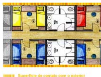
Figura 16 – Desenho da união de containers com otimização dos espaços internos e redução de áreas expostas às intempéries. A porção não colorida – nesse exemplo, os sanitários - não sofre alterações de layout.
