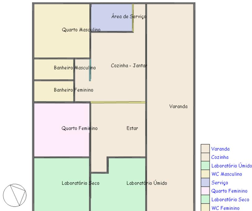
Figura 5 – Planta baixa do modelo simulado no Design Builder.
