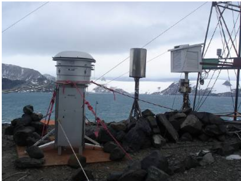
Equipamento de coleta de PM 10 e Sensores Meteorológicos instalados na área Sudoeste/Sul nas proximidades da EACF, durante o verão de 2007.
