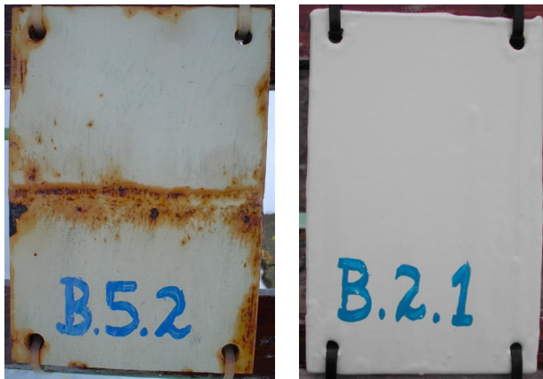
Figura 1- Corpos-de-prova expostos por 18 meses na Estação Antártica Comandante Ferraz, sendo ambos de aço carbono com esquema epóxi branco.
