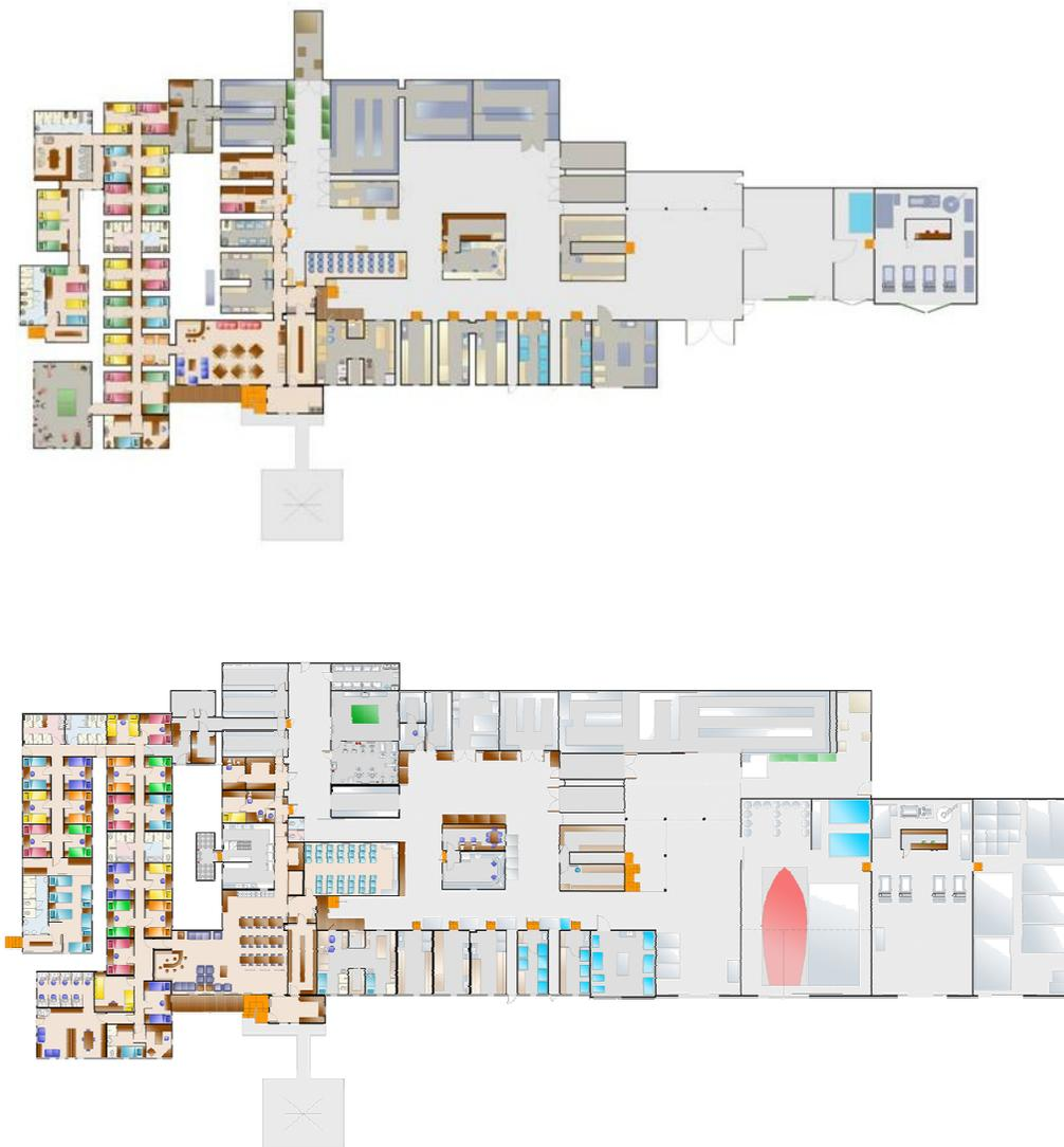
**Figura 10 – Acima, arranjo atual da EACF (área = 1.660 m<sup>2</sup>; perímetro = 525 m); abaixo, arranjo proposto pelo Plano Diretor (área = 2.410 m<sup>2</sup>; perímetro = 362 m).**
