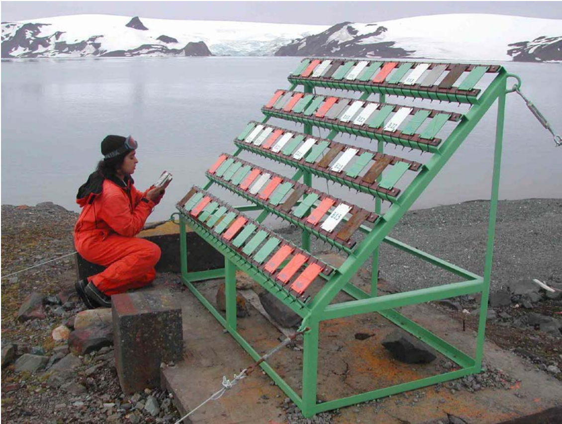
Figura 1 – Suporte principal da Estação de Corrosão Atmosférica Comandante Ferraz.
