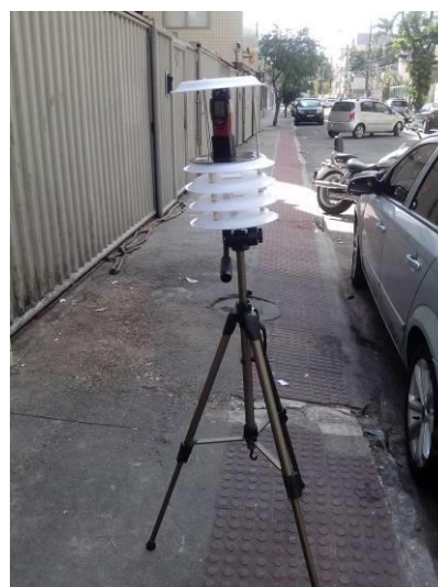
Figura 7: Miniestação. À esquerda, detalhe do abrigo.
