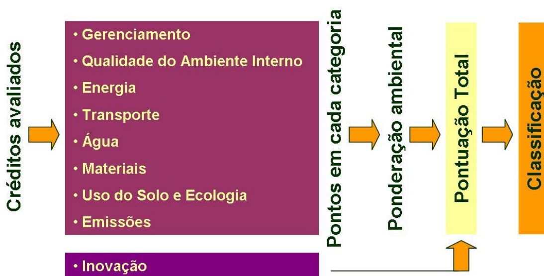
Figura 11 - Estrutura básica de classificação do Green Star (GBCA, 2005)
