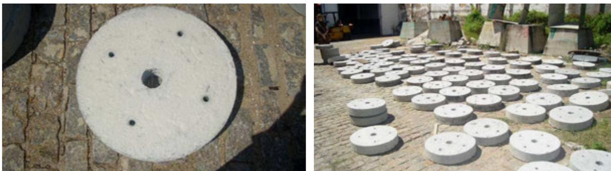
Figura 5:15 – Discos de concreto armado, em processo de fabricação na BNN, numa etapa antecedente à 1ª expedição. Imagens: M.A. Carvalho, 2007.
