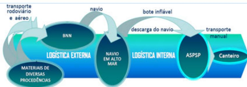
Figura 4:3 – Esquema da logística aplicada no processo produtivo das construções no ASPSP.
