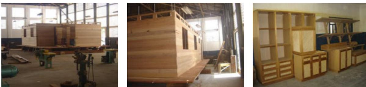
Figura 5:36 – Pré montagem da nova Estação e seu mobiliário nas dependências da marcenaria da BNN.
