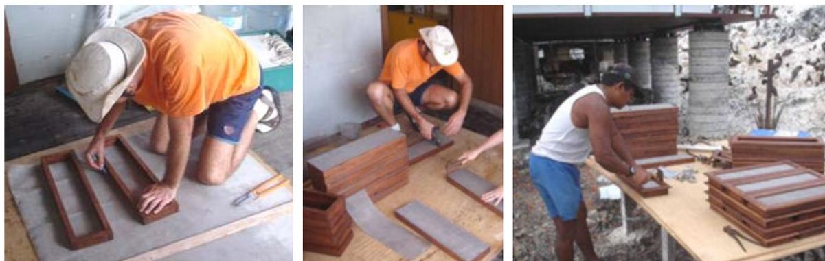
Figura 5:48 – À esquerda, marcação para corte do tecido telado, no centro, o grampeamento nas molduras e, à direita, associação dos marcos às molduras. Imagens: acervo LPP/UFES, 2007.
