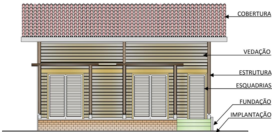
Figura 3 – Esquema dos subsistemas, baseado em Benevente (1995).
