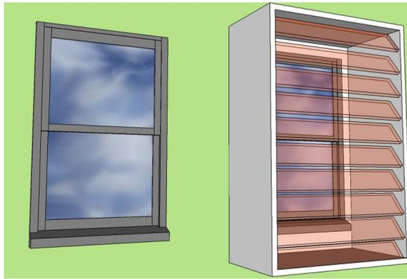
Figura 8 – Exemplo de aberturas com e sem proteção solar externa.
