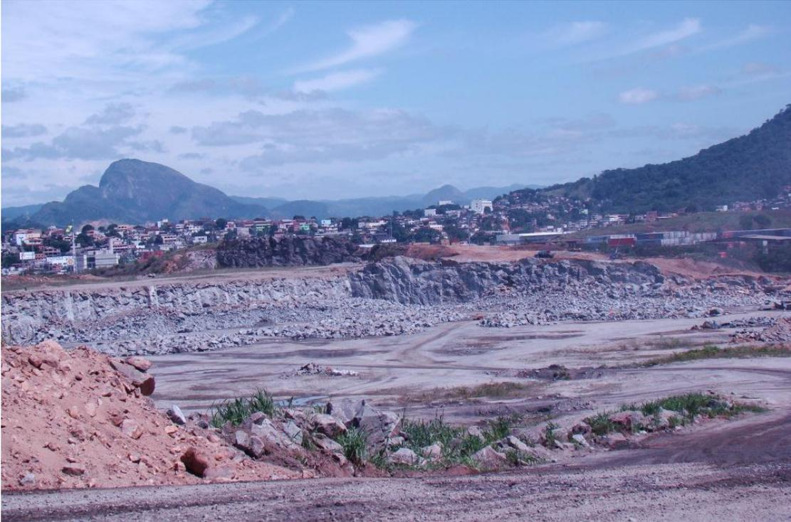
Figura 18: Extração voltada para a conformação de platôs que serão destinados à área retroportuária na Rydien Mineração.
