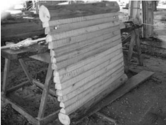
Figura 2. Teste inicial de montagem do sistema. Imagem: Emanuella Sossai Altoé
