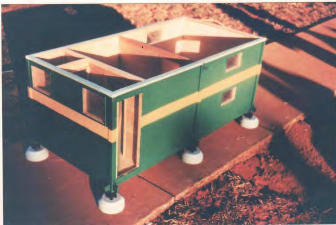
Figura 68 - Maquete do Refúgio Emílio Goeldi em escala 1:5 para teste preliminar dos encaixes previstos em projeto (Foto da autora, 1988).
