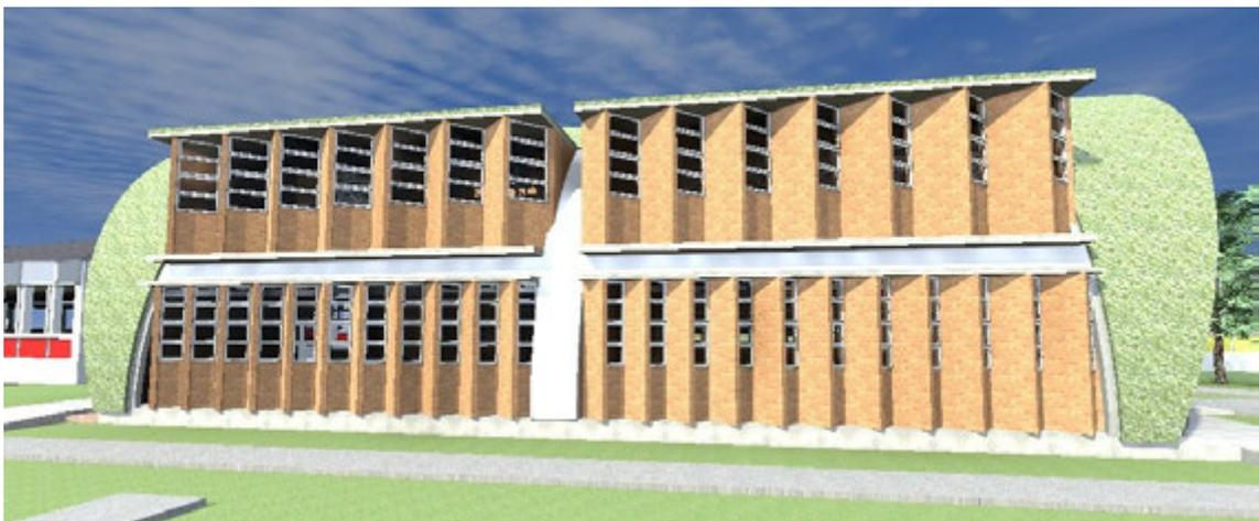
FIGURA 23: Fachada sudoeste: redirecionamento das aberturas para entrada de iluminação natural e proteção contra a intensa insolação.
