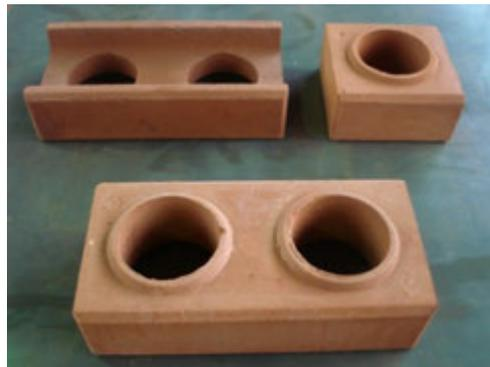
FIGURA 45: Tijolo, meio-tijolo e tijolo canaleta do módulo selecionado. Observando-se que o tijolo canaleta não foi utilizado no edifício. Fonte: GRUPO..., acesso em 20 jun. 2012.
