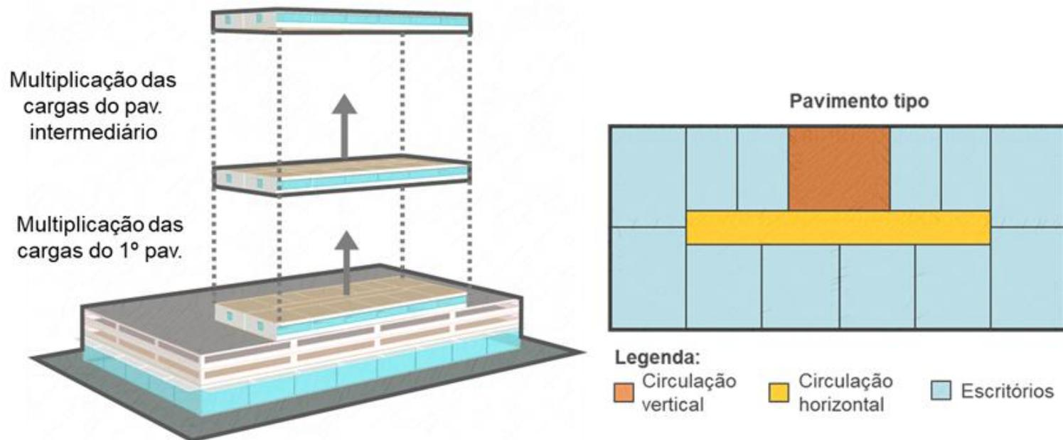
**Figura 6** Simplificação da modelagem e setorização dos ambientes
