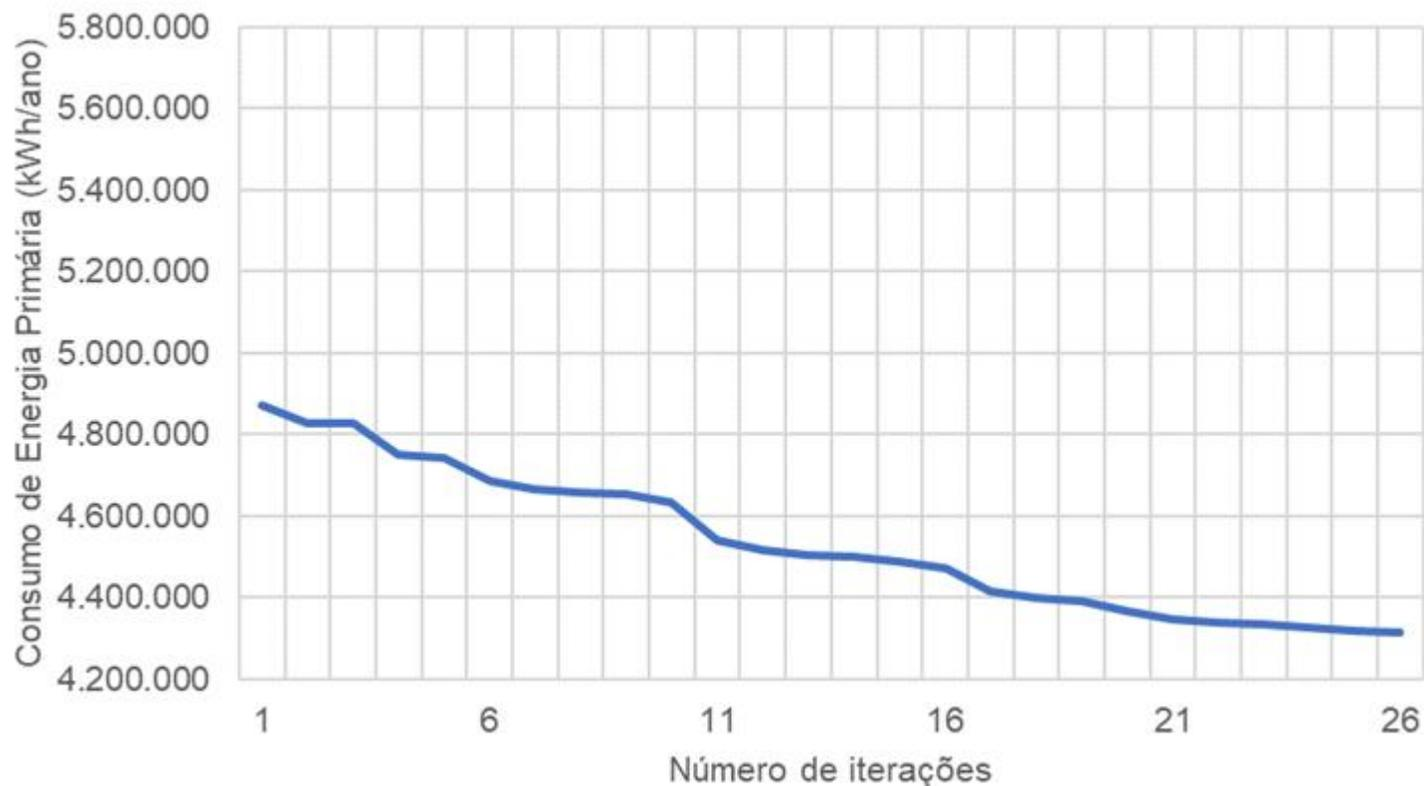
**Figura 9** Monitoramento de convergência da proposta de otimização abrangente
