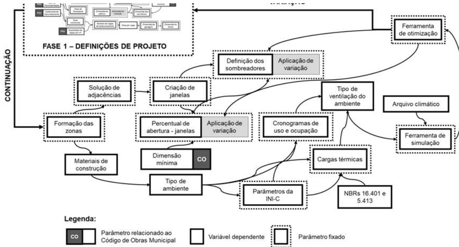
**Figura 5** Esquema do código do sistema generativo de projeto referente à modelagem energética: (a) visão geral do código em VPL; (b) visão ampliada do código de programação em VPL referente às definições de projeto; (c) esquema simplificado do código de programação referente à modelagem energética
