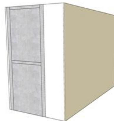
**Sistema construtivo da parede:** bloco de concreto com isolamento térmico
