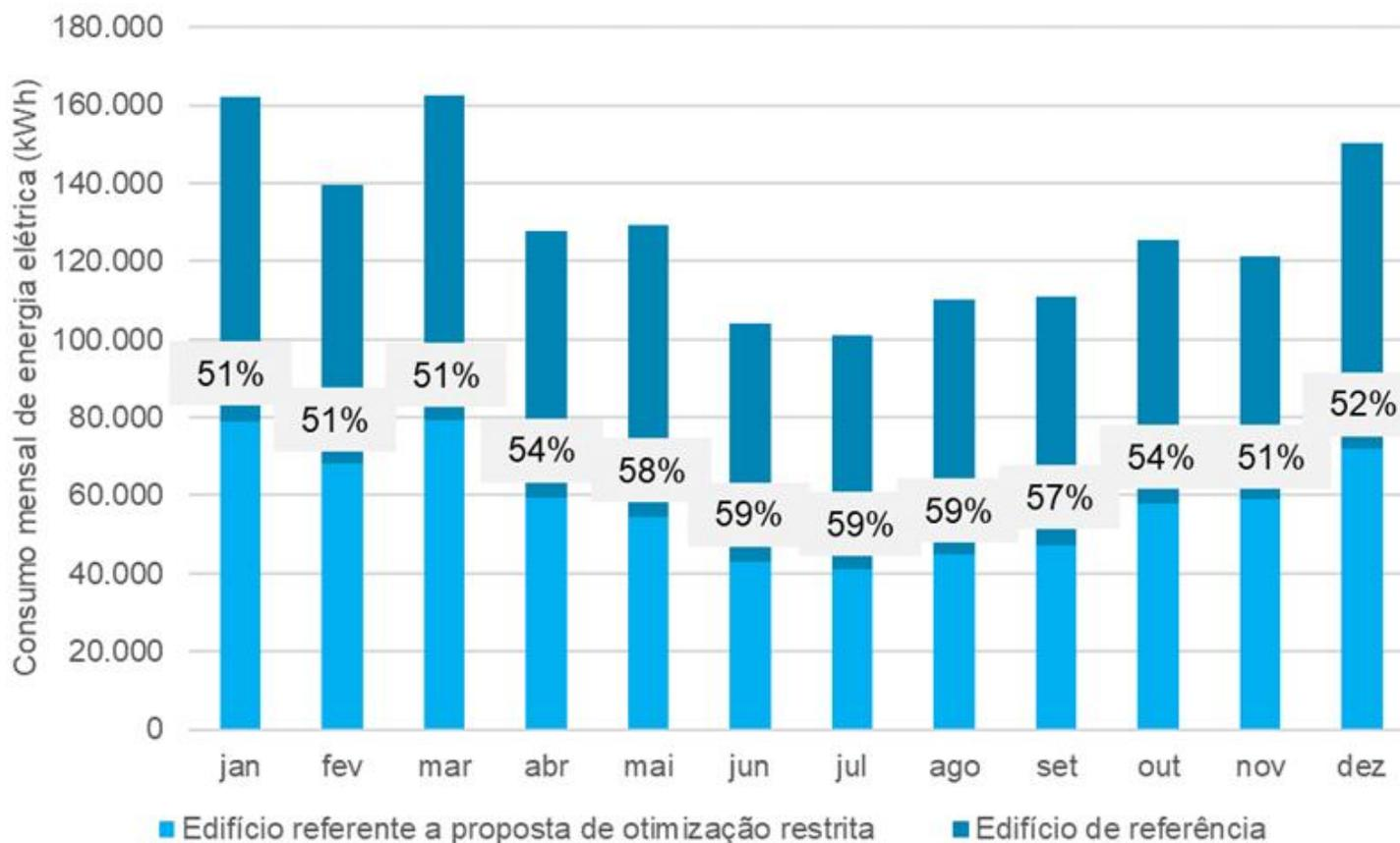
**Figura 14** Consumo de energia elétrica do sistema de resfriamento na modelagem de otimização restrita
