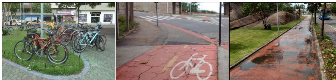
*Figura 04 – À esquerda, exemplo de poucos estacionamentos para bicicletas; ao centro, pavimentação inadequada com descontinuidade da via; e à direita, drenagem ineficiente. Fonte: autores*
