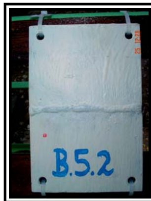
Figura 5 – Corpo-de-prova aço carbono, início da exposição em 25/01/2004.
