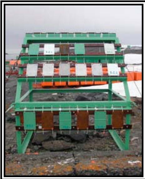
Figura 3 – Suporte auxiliar com corpos-de-prova com ângulos em relação ao plano horizontal de 0°, 45° e 90°.
